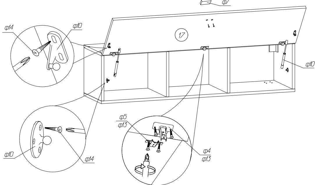
*Схема установки задней стенки шкафа
