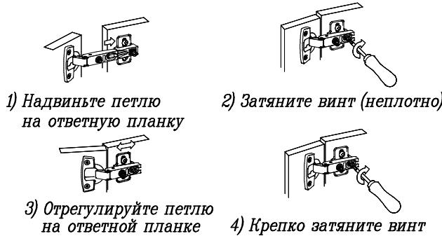
*Схема регулировки петли*
