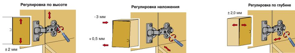
Слегка ослабить крепежные винты ответной планки, выверить по высоте позицию двери. Затем крепежные винты снова затянуть.
