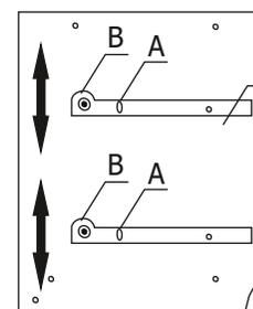
**Регулировка направляющих по высоте:**
