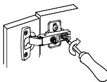
2) Затяните винт (неплотно)
