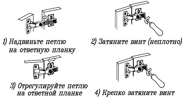
*Схема регулировки петли*
