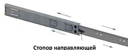
Перед установкой направляющие нужно разъединить. Для этого стопор правой направляющей следует поднять вверх, левой - опустить вниз. Затем соединить их, вставив друг в друга, произойдет щелчок.
