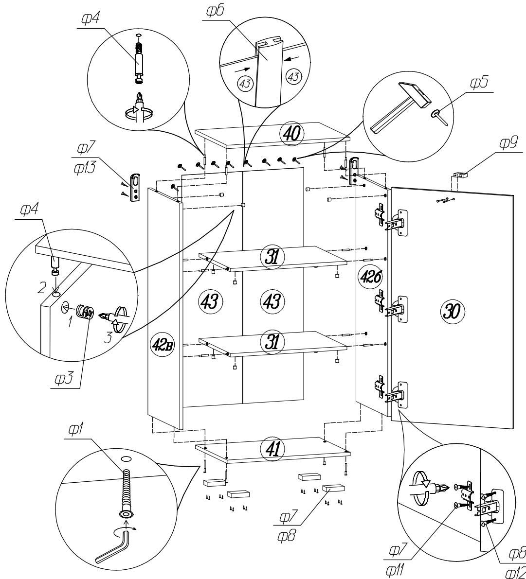
*Схема установки задней стенки шкафа
