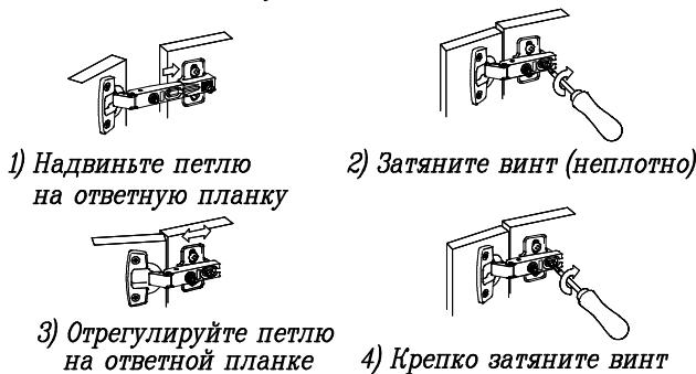
*Схема регулировки петли*
