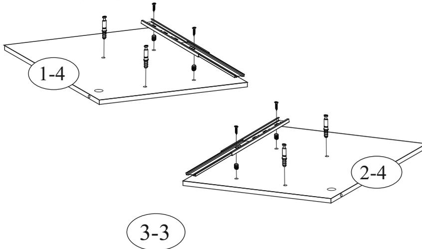
3. При помощи евровинтов 6,3х10,5 закрепите металлические навесы (К-139) на колпак верхний (поз.3-4). Вкрутите дюбеля стяжки (К-10).
