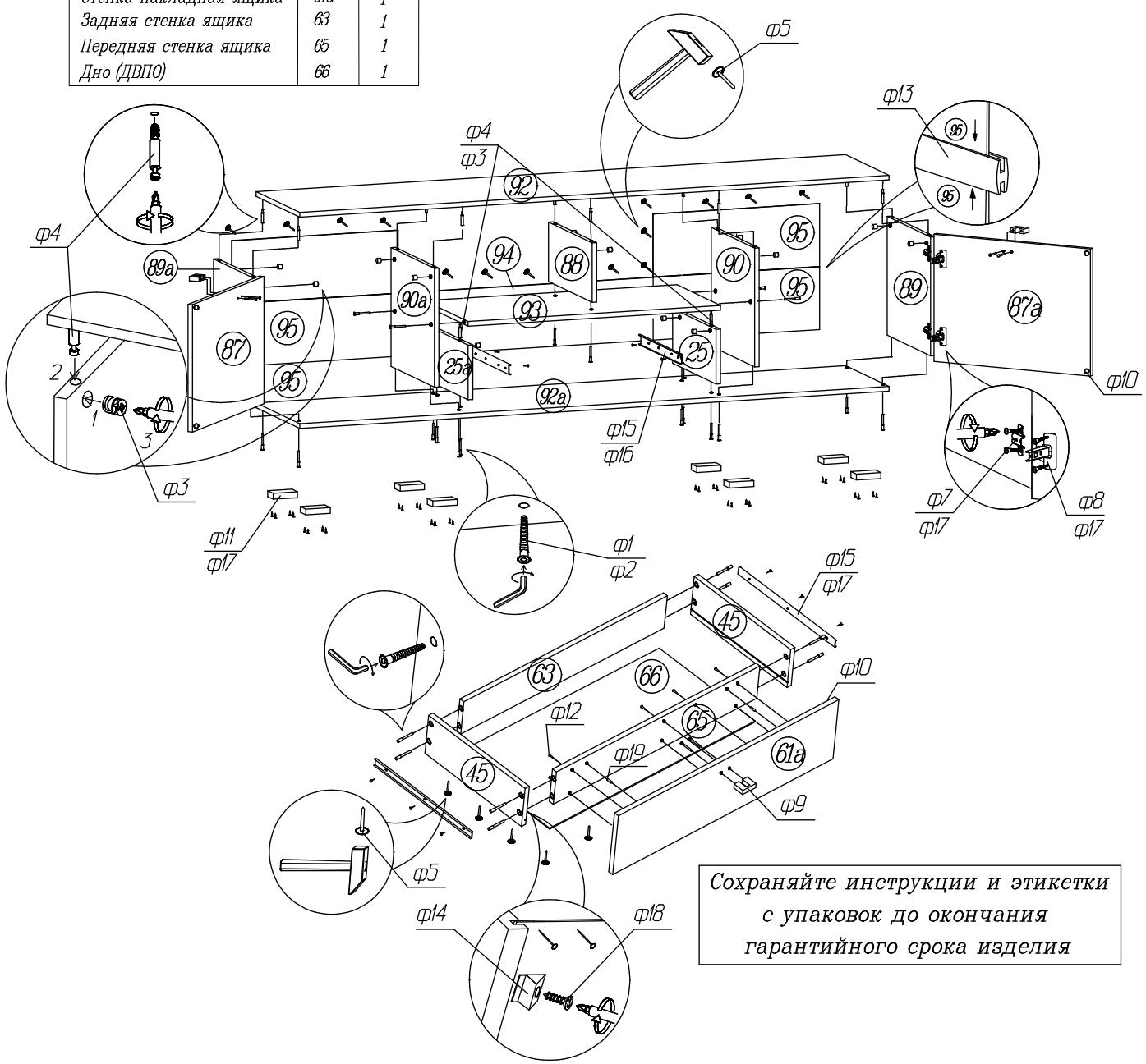
*Схема установки задней стенки шкафа
