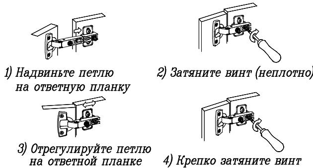
*Схема регулировки петли*
