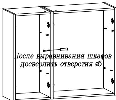
Во избежание опрокидывания шкафа, зафиксируйте его с рядом стоящими шкафами, просверлив самостоятельно отверстия Øб мм в стенках вертикальных и скрепив их между собой стяжкой межсекционной.
